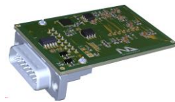
Smart City CO2 Temperatur Luftfeuchtigkeit Luftdruck Geräuschpegel Helligkeit Neigung Vibrationen
